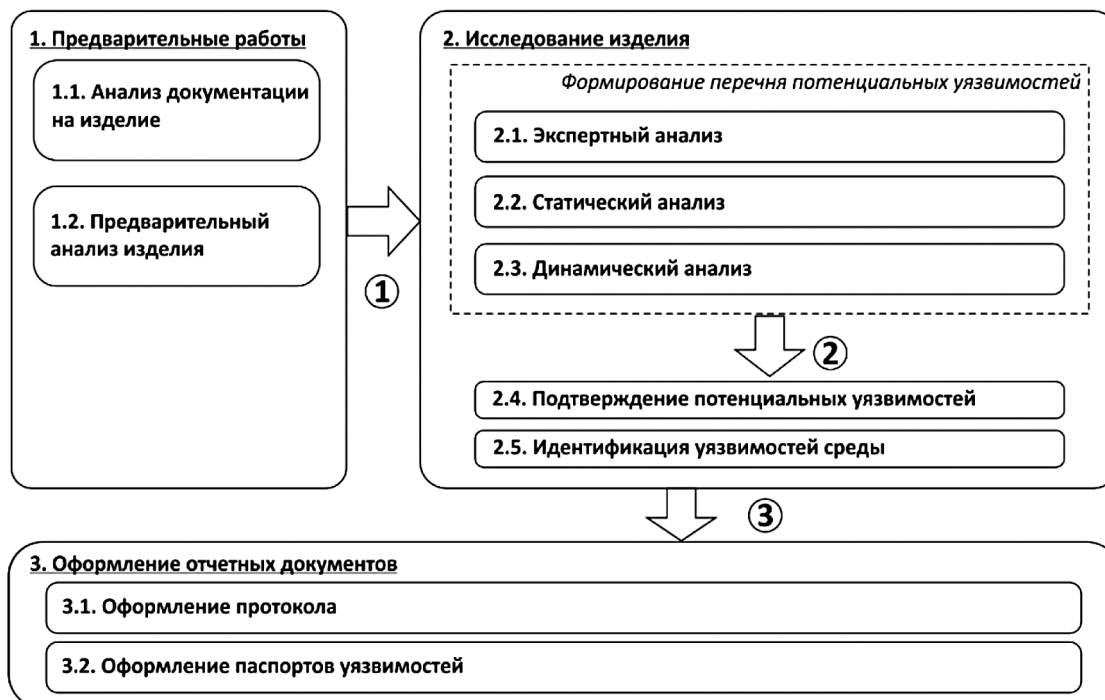
Рис. 7. Концептуальная модель выявления уязвимостей в процессе сертификационных испытаний программ
