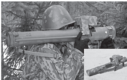
Рис. 4. Внешний вид унифицированного прицельно-пускового устройства для пехотных огнеметов нового поколения
