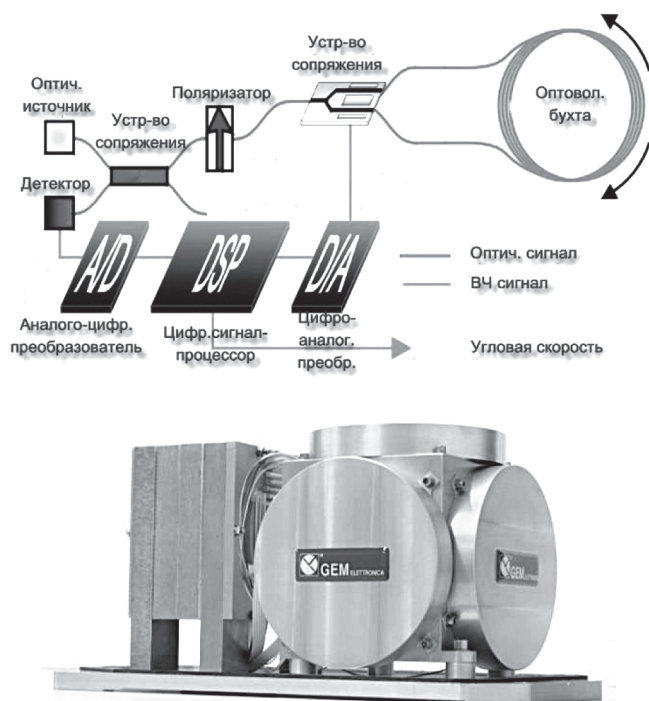
Рис. 10. Волоконнооптический гироскоп: (а) структурная схема, (б) внешний вид.
