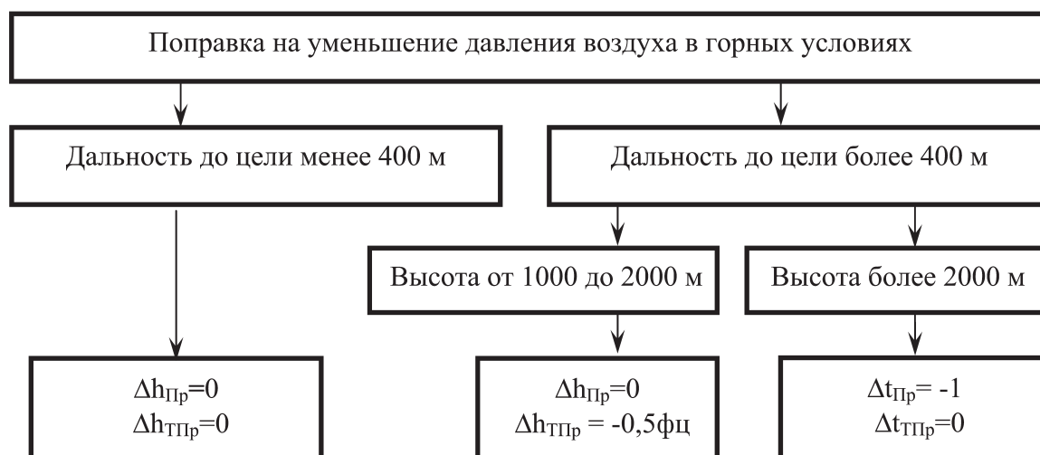
Рис. 2. Поправка на уменьшение давления воздуха в горных условиях
