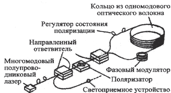
Рис. 6. Схема волоконно-оптического гироскопа с фазовой модуляцией
