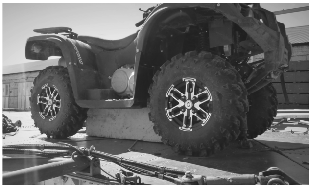
Рис. 2. Схема центровки и крепления квадроцикла на парашютной платформе
