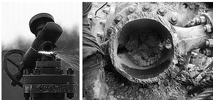
Рис. 10. Дистанционная лазерная резка несущих конструкций и оборудования толщиной до 15–25 мм во время пожара на буровой установке на расстоянии 70–100 м с использованием обычных серийных технологических волоконных (ранее – CO 2 -лазеров) лазеров [26]
