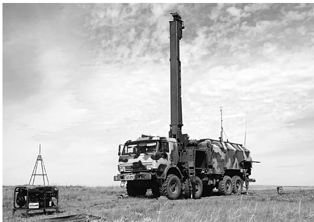
Рис. 3. Звукотепловая станция 1Б80 из состава автоматизированного звукотеплового комплекса артиллерийской и войсковой разведки «Пенициллин» (изделие 1Б75)
