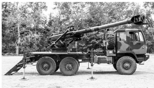
Рис. 8. Опытный образец 155-мм СГ «Брутус» (Brutus) «следующего поколения» (NGH) на колесном шасси
