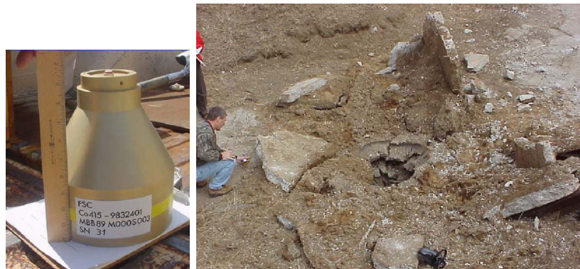
Рисунок 10 – Инженерный КЗ с РМ (Ø200мм, 5,28кг ВВ) и его действие по ж/б плите (ширина 2,44 м, длина 7,31м, толщина 0,14 м). Диаметр воронки более 2,44 м, глубина каверны 1,32м
