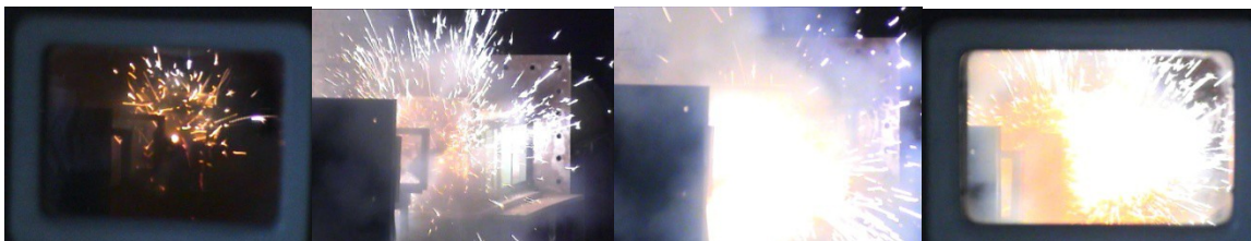
Рисунок 3 – Типичный опыт на моменты времени 1, 3, 8 и 11 мс (скорость 990 м/с)
