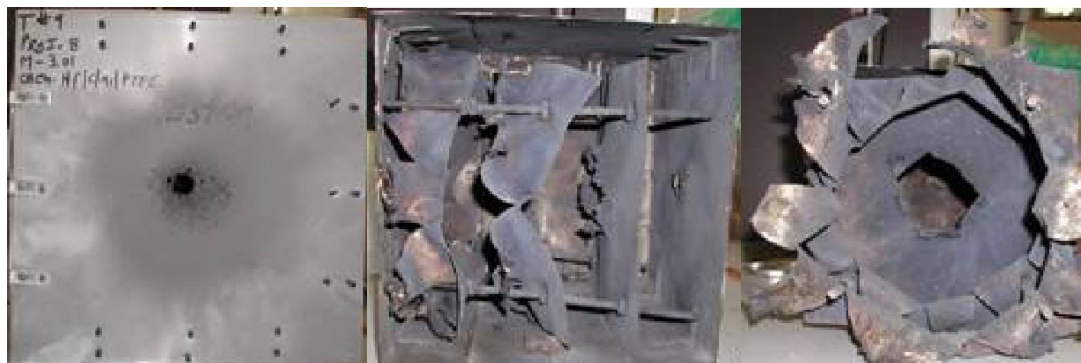
Рисунок 6 – Удар РМ-ПЭ (Ал/ПТФЭ) по набору разнесенных пластин, скорость 3,134 км/с [4]
