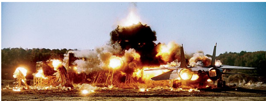
Рисунок 8 – Полномасштабное испытание БЧ с РМ-ПЭ в рамках программы «Перспективный боеприпас на основе реакционных материалов»; показана возможность увеличения радиуса поражения в ~2 раза, вероятности поражения в ~6 раз [5]
