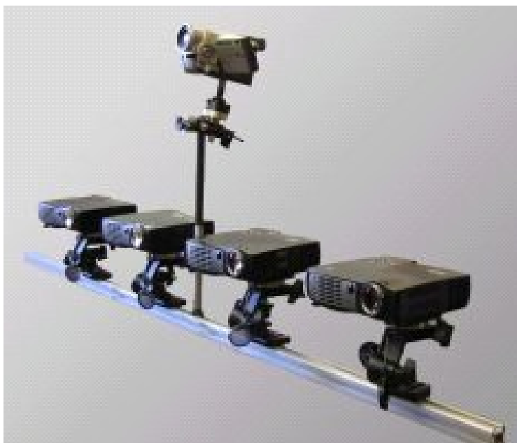
Рисунок 2 – Система из четырех проекторов и камеры, смонтированных на одном основании
