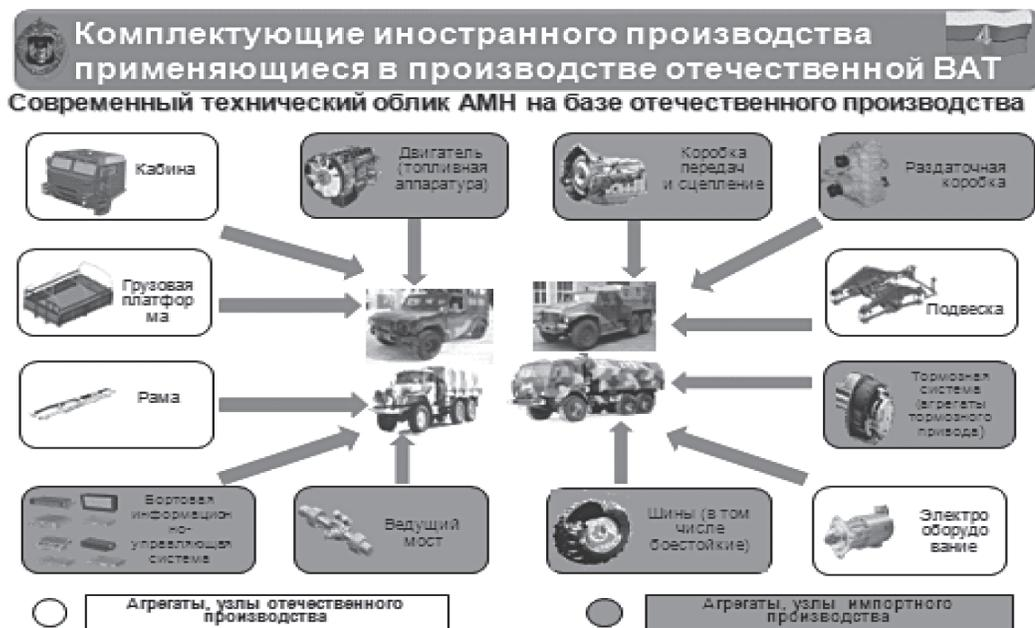
Рис. 1. Современный технический облик военных автомобилей на базе отечественного производства
